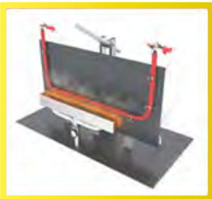
FIRE RESISTANCE (EN 50200 PH 1 5-30-60-90-120) IEC 60331-2:2018 (Diam <20mm) IEC 60331-1:2018 (Diam >20mm)
